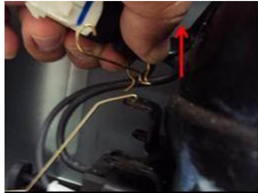
6.- Mantener presionado el Clip y desplazarlo hacia arriba con el objetivo de liberar los 2 ganchitos que tiene el Clip (un gancho en cada extremo) del bracket del Compresor.
