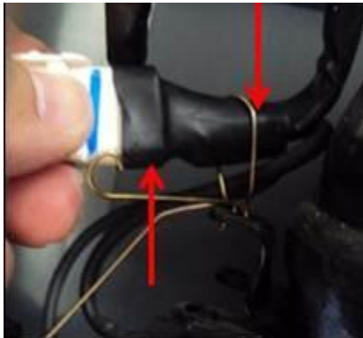
4.- Jalar o desplazar el conector hacia afuera del gabinete con la finalidad de que la parte más gruesa del conector quede libre del Clip.
