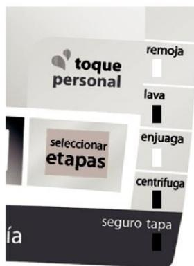
**sólo enjuaga y centrifuga:** Realizará el drenado del agua, se encenderá el indicador de centrifugar, llenará la tina con agua limpia y realizará la agitación de enjuague, a continuación se encargará del drenado de agua y centrifugado de la ropa.
