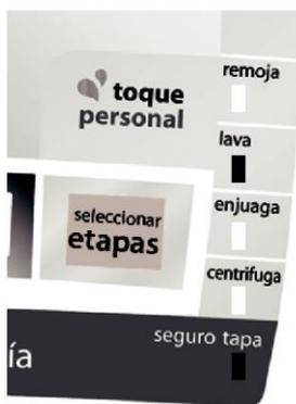
**sólo enjuaga:** Realizará el drenado y centrifugado del agua; mientras el indicador de **centrifuga** permanecerá encendido, posteriormente se llenará la tina con agua limpia y realizará la agitación de enjuague finalizando esta etapa, sin hacer el drenado del agua al final, permaneciendo encendido el indicador de **enjuague**.
