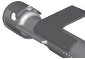
10. Si la unidad está equipada con asador a gas, ajuste el obturador de aire a la posición de "NAT", aflojando y ajustando nuevamente el tornillo que lo sujeta.
